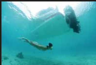
シュノーケリング中の様子を水中から。船底形状はトランサムデッドライズ21度のディーブV。船尾には艇体と一体のモーターブラケット部分が張り出し、その下に大きめのフラップが備わっている
