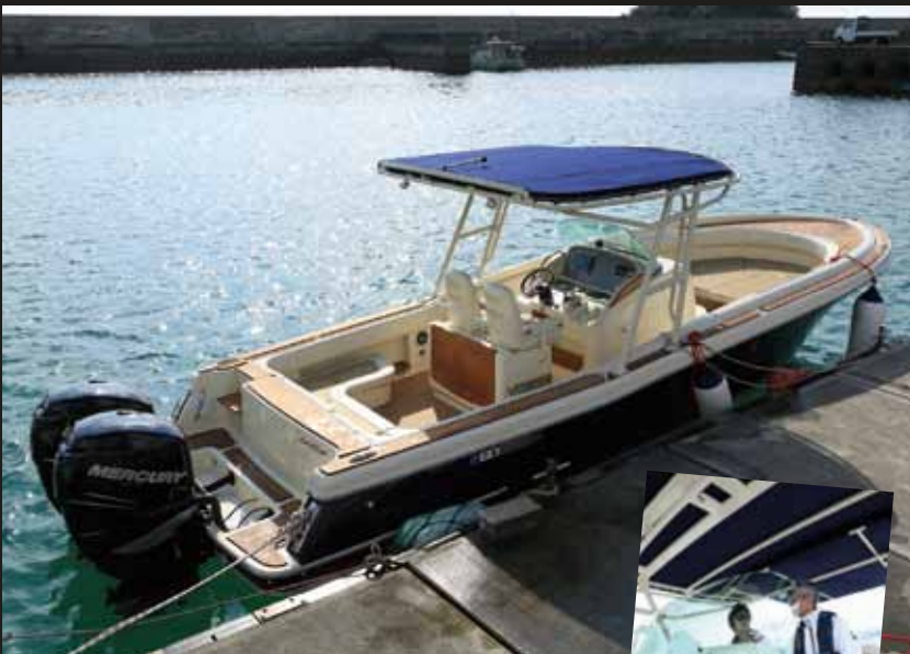
(●●●●●●●●●●)の拠点である祖納(そない)港にて。パウデッキとサイドデッキ、スイムプラットフォームなどはチーク張り。オプションで、フロア全面をチークにすることも可能だ
